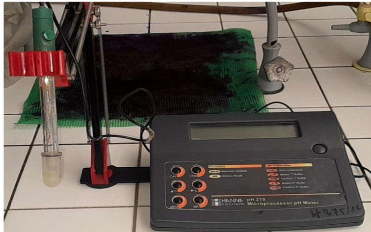
الشكل 16 : صورة جهاز قياس معامل الحموضة
